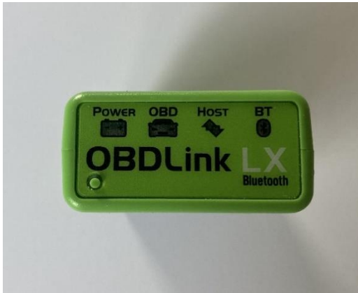
Abbildung 39 OBDLink LX Bedienfeld
