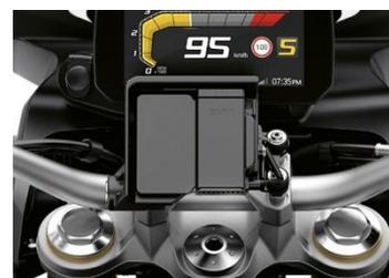
Abbildung 15 Navigationsvorbereitung Halterung
